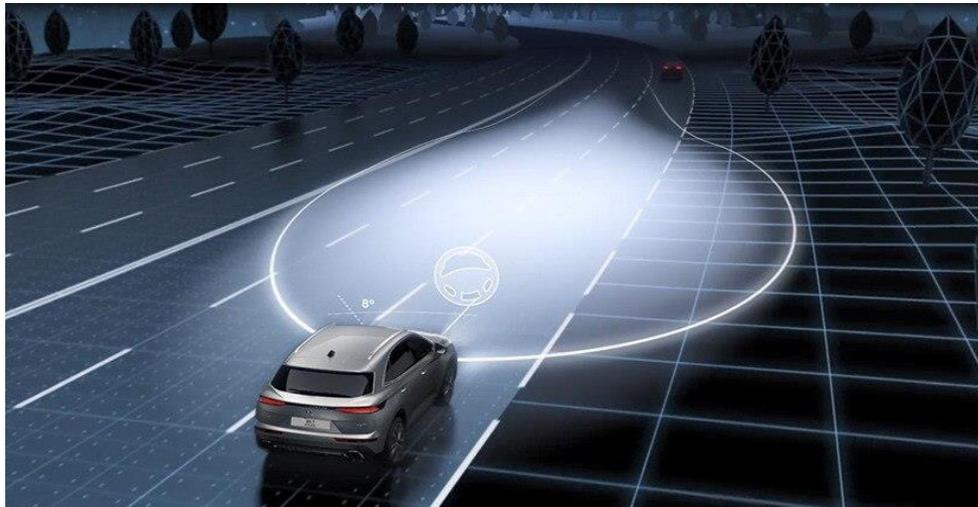
En beneficio de su seguridad, los faros inteligentes DS PIXEL LED VISION 3.0 se adaptan a su entorno ajustando la iluminación en función de las condiciones exteriores (ciudad, campo, clima, etc.) y dirigiendo la luz hacia las curvas para mejorar la visibilidad en las mismas.
