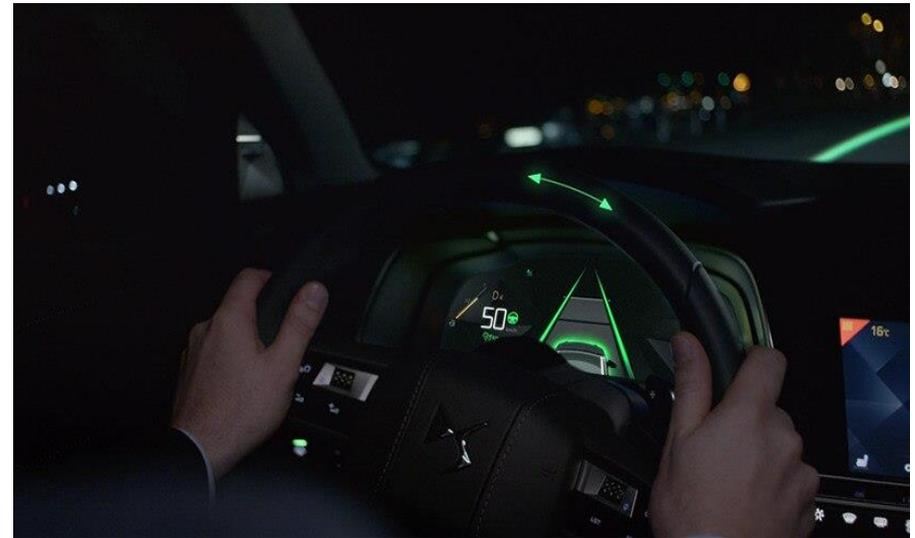
Hemos diseñado el DS DRIVE ASSIST para ayudar al conductor y permitirle retomar el control del coche en cualquier momento. Este sistema ajusta la velocidad y la distancia con respecto al vehículo que le precede y posiciona el DS 7 con precisión en su carril, controlando la dirección si el conductor lo desea. Supervisa la velocidad y la dirección, garantizando la seguridad y la tranquilidad al volante.
