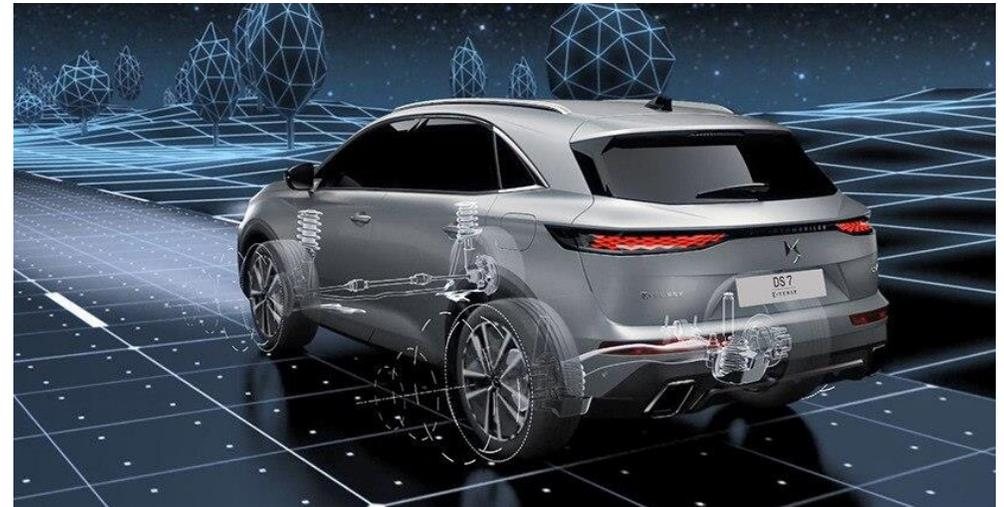
Este sistema de suspensión inteligente utiliza una cámara situada en la parte superior del parabrisas, así como varios sensores, para explorar las imperfecciones de la carretera en tiempo real. Este sistema transmite estos datos en milisegundos a un ordenador que actúa sobre cada una de las ruedas de forma independiente. En función de la información que recibe, endurece o ablanda continuamente la suspensión para garantizar el mayor confort posible al conducir el DS 7.
